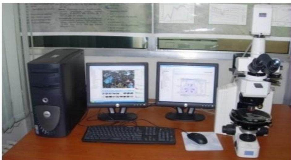
Канадын хөгжлийн агентлагийн (CIDA) төслөөр авсан петрографи-минераграфийн судалгаанд зориулагдсан иж бүрэн NIKON микроскоп, компьютер, зургийн аппаратын хамт
